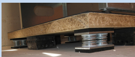
Duripanelplatte mit Stahl Druck-Federelementen und Kippsicherung
